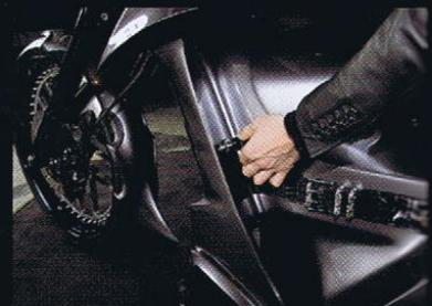
足を乗せるステップの下には、スワロフスキー付き電動スタンドを装備。イグニッションと連動し格納され、レースカーのエアジャッキみたいで超カッコイ!
