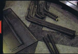
バイクの設計図に基づいて、フレームを構成するパイプを切り出していく。
