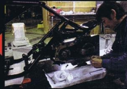
エンジンのフレームは美しく鏡面に磨き上げ、ボルトで固定していく。
