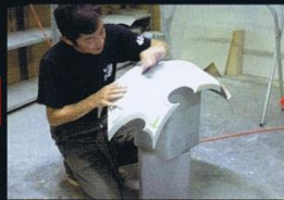
凸部分や曲面はサンドペーパーで磨きながら、キレイに表面を仕上げている。
