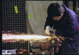
各パイプをサイズ通りに削り出し、曲げて組立・溶接に向けて微調整する。
