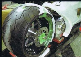
各カウルを仮フィッティングし、フレームやタイヤに干渉しないかチェックする。
