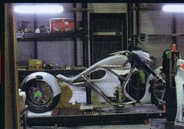
組み上がったフレームに、ボディの各カウルを仮装着すると、こんなイメージだ。
