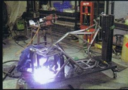
台座の上にパイプでフレームを組み立て、横幕氏が自ら溶接の作業を始める。
