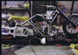
ハンドルと前後のタイヤを取り付け、バイクの骨格であるフレームが完成した。
