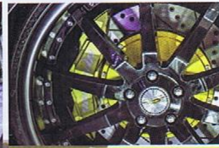
เสริมความปลอดภัยด้วยถุงลมนิรภัยของค่าย VEILSIDE ในด้านหน้าขนาด 6 POT ใหม่ พร้อมจาน 2 ชั้น ส่วนด้านหลังมีขนาด 4 POT พร้อมจาน 2 ชั้น
